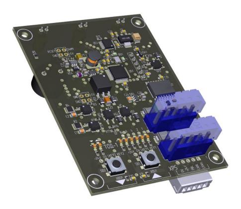
Плата контроллера представляет из себя устройство сбора данных, индикации и управления. Контроллер обеспечивает сквозное подключение к шине CANbus, в базовых функциях - одновременную обработку двух кнопок вызова, подключение дополнительного устройства в шину CANbus, а также обработку считывателя карт типа Mifare
