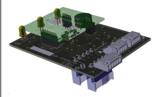
Плата считывателя подключается либо непосредственно на плату ТОД-1 как показано на рис. Либо может быть подключена через удлиняющий шлейф.
