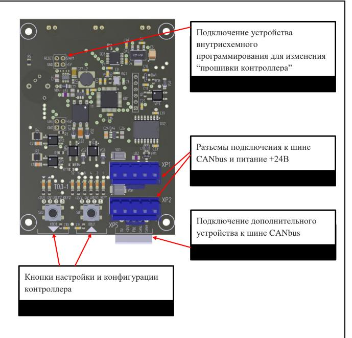
Разъемы подключения CANbus располагаются в верхней части контроллера и при подключении кабелей обеспечивают фиксацию платы в кабель канале (при использовании в кабель канале) либо обеспечивают подключения "сверху" при расположении платы, закрепленной внутри корпуса, расположенного на какой-либо поверхности
